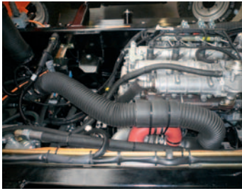
Ansaugung von Motorluft
